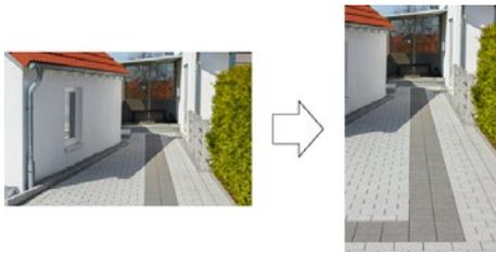
Sie können für die Überwachung von Gängen oder entlang einer Gebäudeseite den Korridor-Modus verwenden. So wechseln wir vom 16:9 in das 9:16 Seitenverhältnis - bei gleicher Auflösung.
