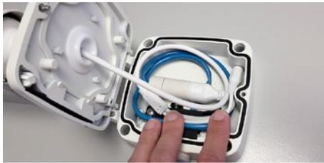
Die Anschlusskabel werden in der integrierten Anschlussbox verbunden. So benötigen Sie keine externe Verteilerdose, um die Kabel im Außenbereich sicher zu verbinden.
